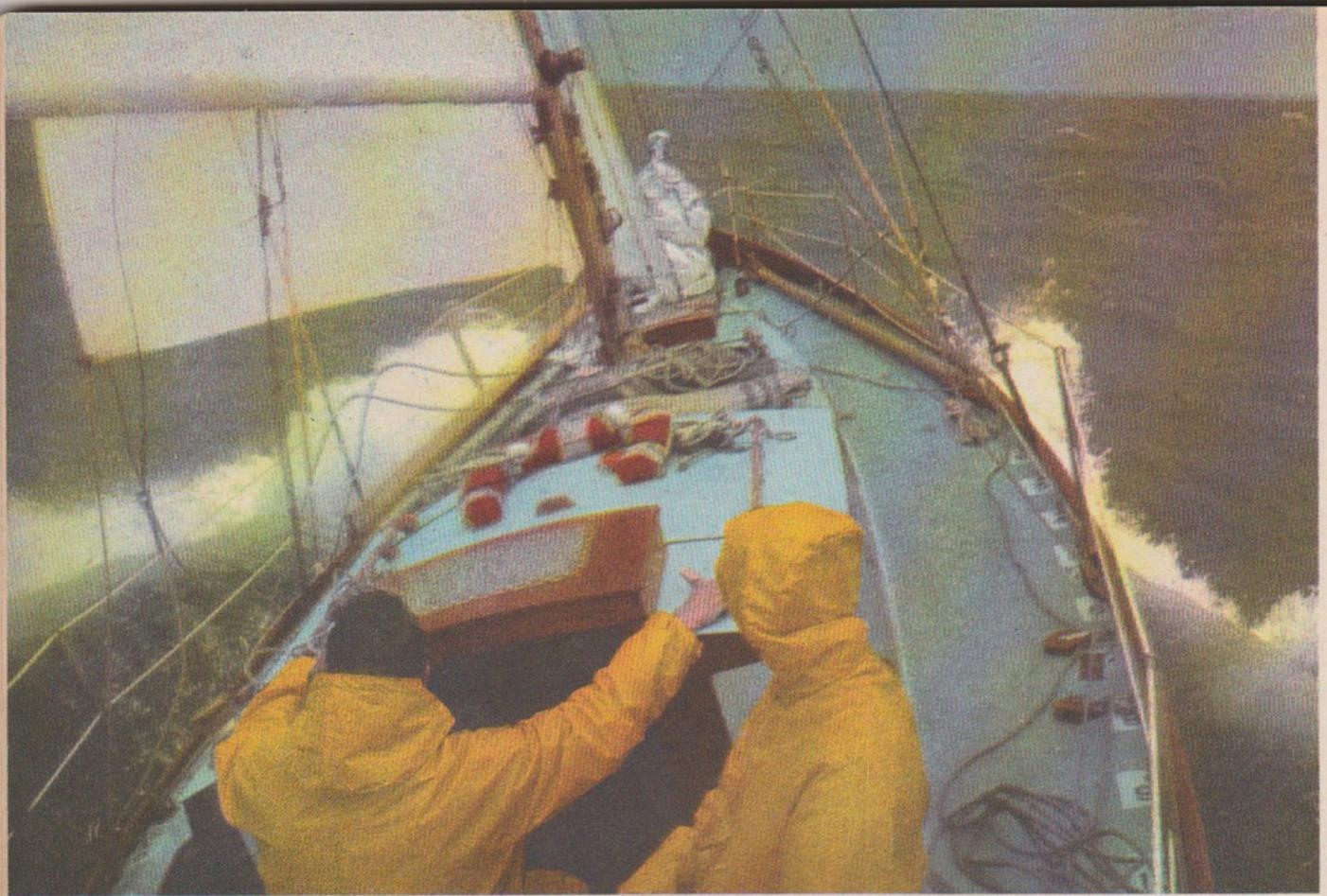
Sous trinquette gênoise et grand-voile roulée, le bateau fonce au large. Le vent était force 7 et la vitesse au speedomètre ne tomba jamais au dessous de 8 nœuds. Ci-dessous, cette photographie intérieure permet d'apprécier les aménagements et notamment les cloisons transversales renforcées par des épontilles, qu'on ne trouve que sur Shangri-La.
